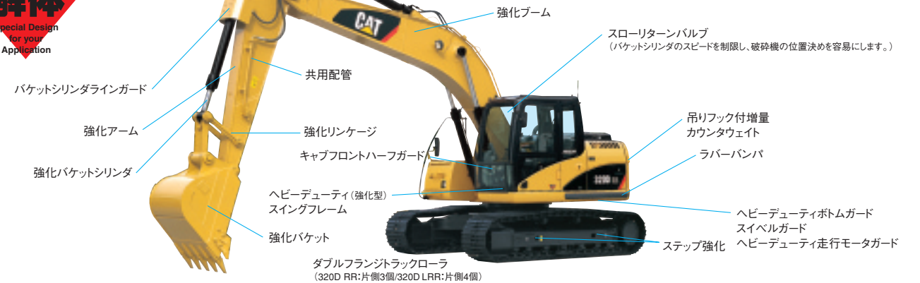
Photo: 320D RR GLD-T6 *引き出し線部は、標準仕様 (GLZ/ GLO) と異なる箇所を示します。
